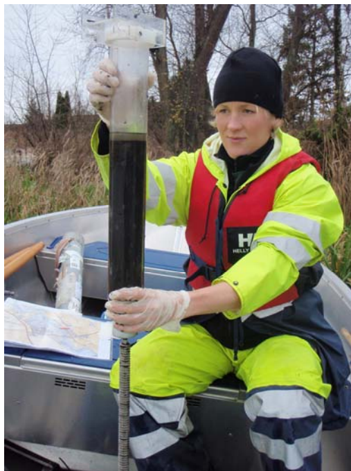
Figur 3: Fotona visar kajakprovtagaren som har använts vid sedimentprovtagning i Kävlingeån.
