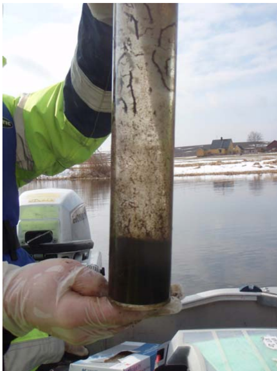
Figur 5: Fotot till vänster visar ett av två plexiglasrör som en fälla består av. Fällan innehåller sediment från en mätperiod. Fotot till höger visar bojarna som hör till SEDFN2.
