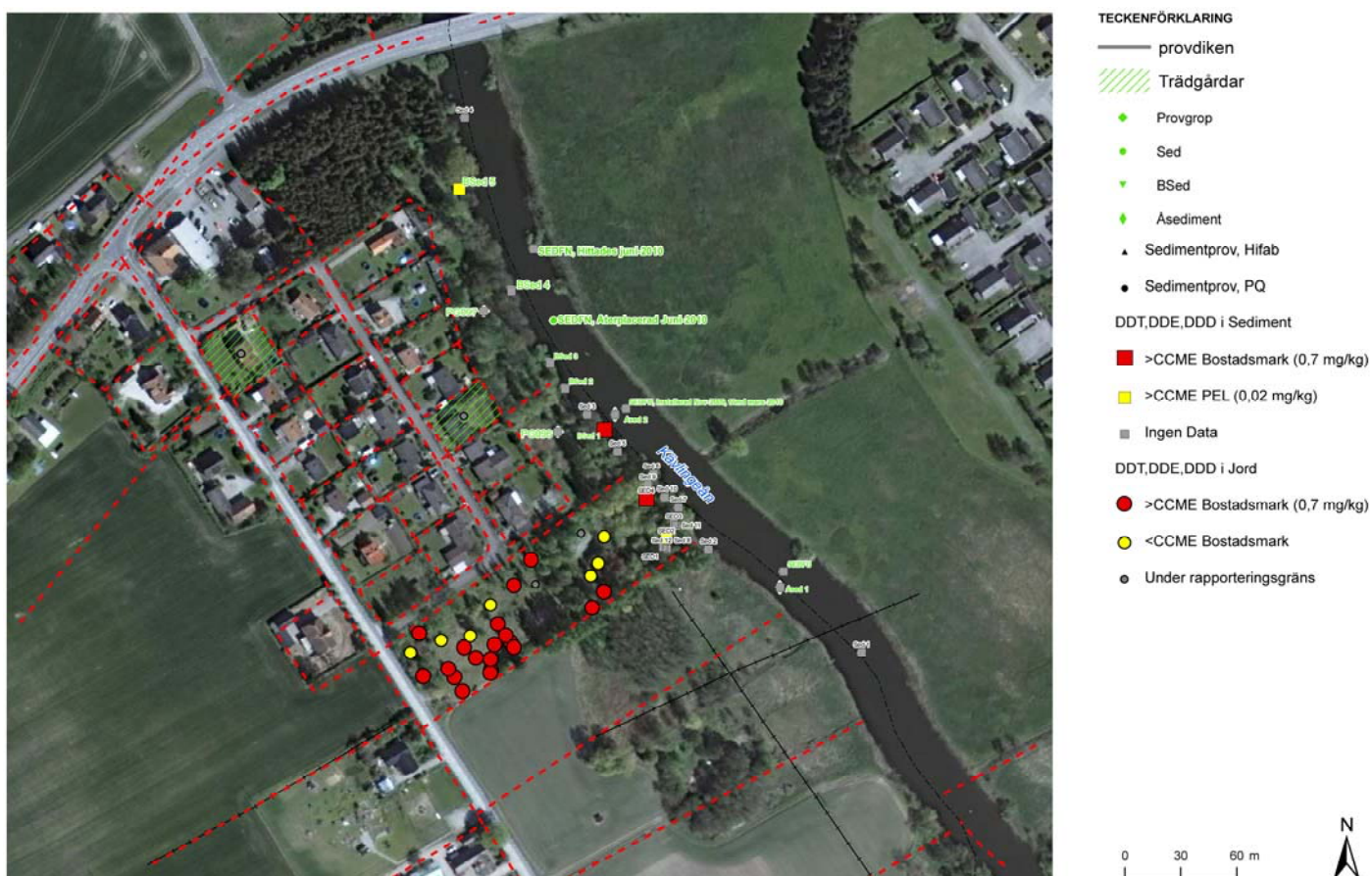
Figur 13: Figuren visar DDT/DD/ DDE i sediment och jord inom Fastigheten, i dess närområde och i Kävlingeån närmast Fastigheten.
