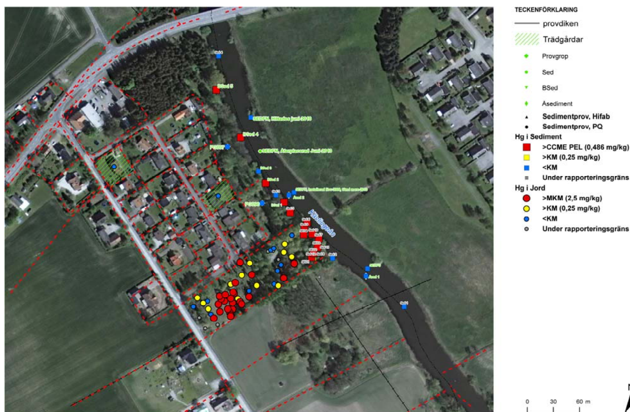
Figur 14: Figuren visar kvicksilver i sediment och jord inom Fastigheten, i dess närområde samt i Kävlingeån närmast Fastigheten.
