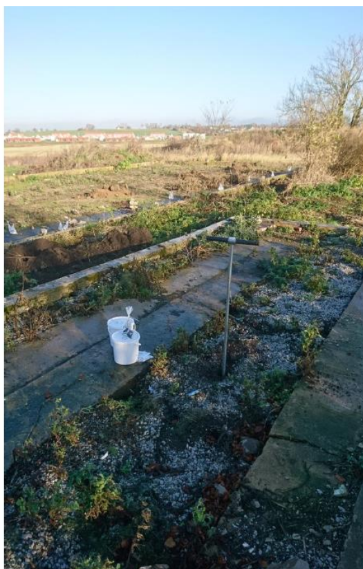
Figur 4 Spadborr användes för tre delprov mellan betongplattor inom samlingsprov SA.
