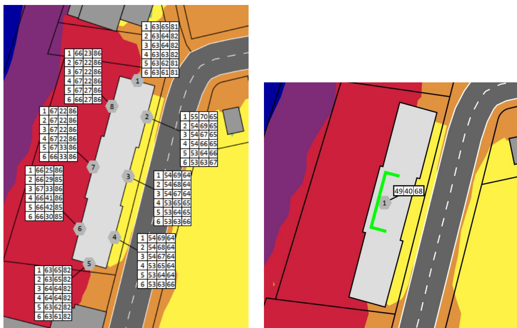
Figur. Urklipp från bilaga AK01 och AK05. Beräknade trafikbullernivåer för nuläge (dimensionerande läge pga. minskad prognos trafik på järnvägen). Tabellerade värden är frifältsvärden och avläses "Våning / L_{eq} / L_{max} väg / L_{max} järnväg". Till höger: bullerskyddad gemensam uteplats på byggnadens tak med 2 meter hög skärm (grön).
