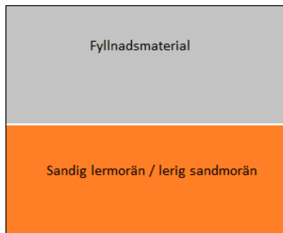
Figur 2: Principiell skiss över dimensionerande jordlagerföljd.
