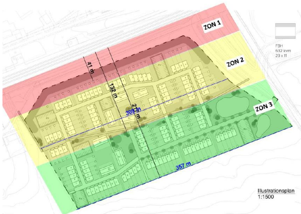
Indelning av riskzoner från järnvägen
