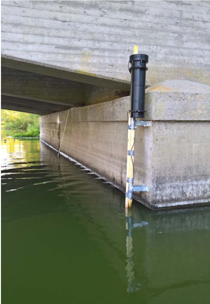
Bild 2. Turbiditetsmätare SWQ2. Bilden tagen i september 2016.
