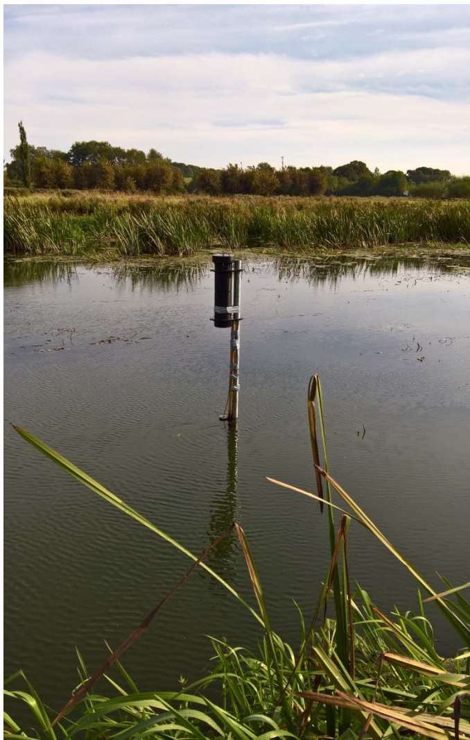
Bild 1. Turbiditetsmätare SWQ1. Bilden tagen i september 2016.
