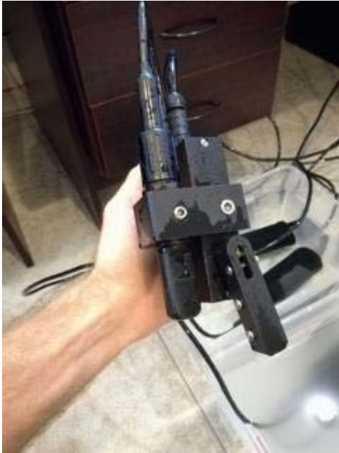
Bild 3. Installerade mekaniska torkare på turbiditetsmätarens sensor.
