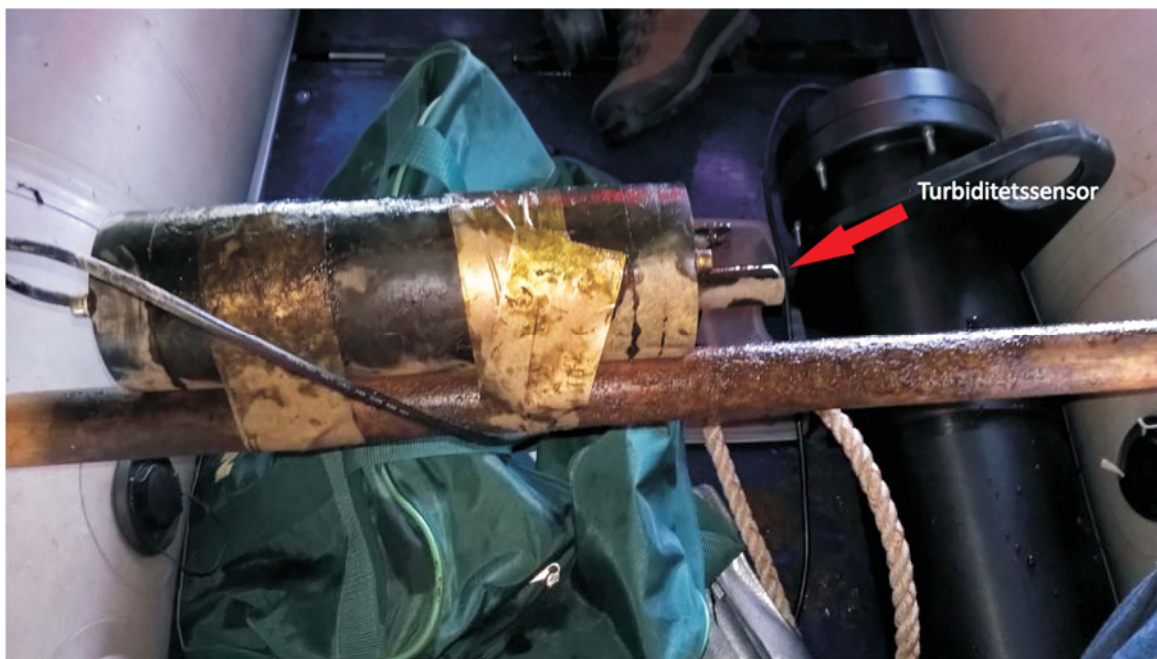
Bild 4. Betydlig påväxt av biologiskt material på mätare SWQ1 mindre än en månad efter installation (12.10.2016).
