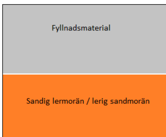
Figur 2: Principiell skiss över dimensionerande jordlagerföljd.
