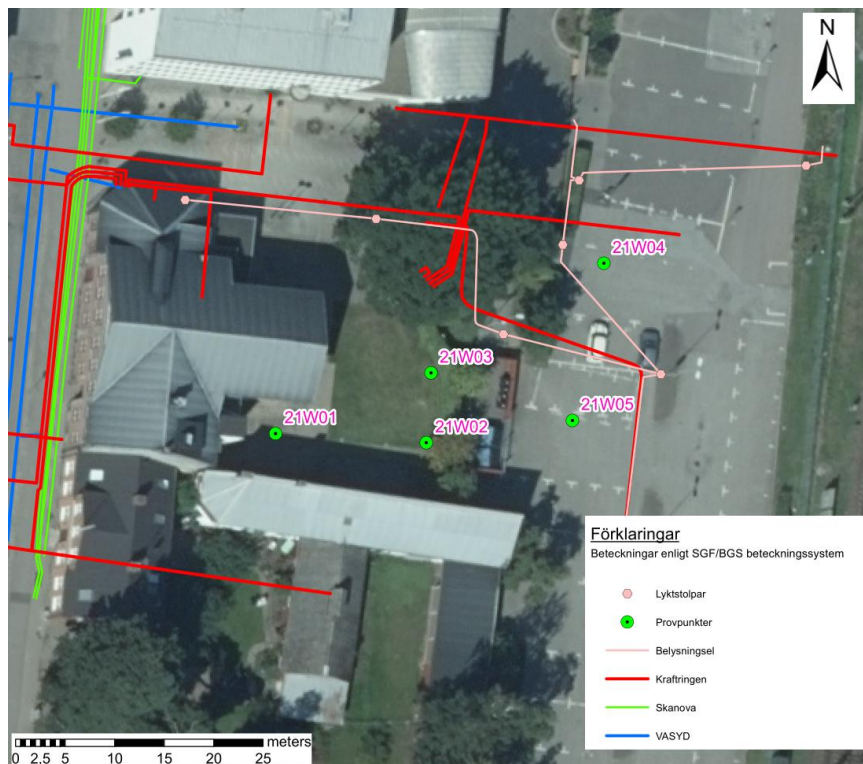
Figur 3: Ledningskarta. Urklipp från uppritad borrhplan, interna ledningar ej visas här.
