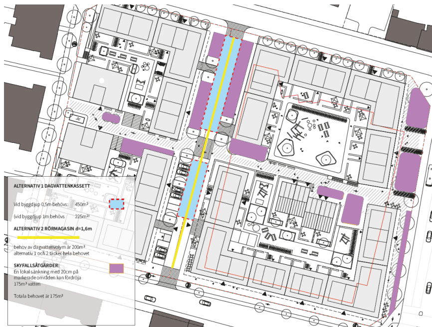
Diagram över dagvatten- och skyfallsåtgärder. Ljusblå visar område som behövs för dagvattenhantering, lila område som behövs för skyfallshantering.
