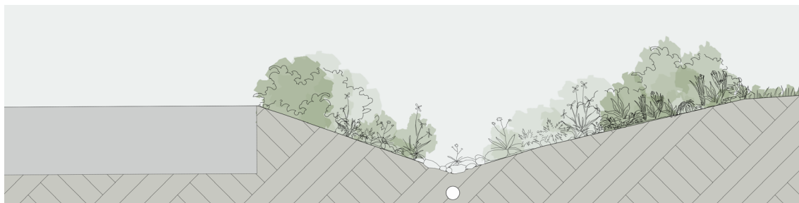
Figur 14. Utsnitt över hur svackdikena som leder vatten till dagvattendamm kan komma att utformas. Danielsen Spaceplanning & Architecture AB
