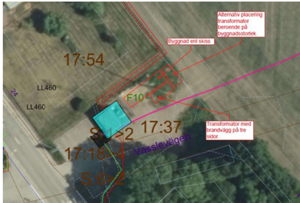
Bild 4. Förslag på den nya transformatorstationens placering.
