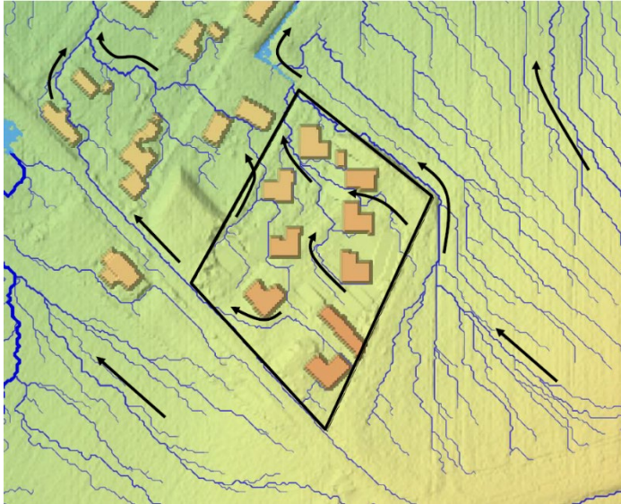
Figur 11. Utsnitt som från dagvatten- och skyfallsutredningen som visar översvämningar och avrinningsstråk vid ett 100-årsregn efter exploatering av planområdet (Scalgo, 2021).
