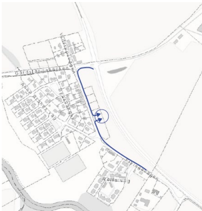
Figur 18. Kartan visar hur dag- och skyfallsvattnet som faller inom planområdet ska ledas till dagvattendammen i mitten av planområdet.
