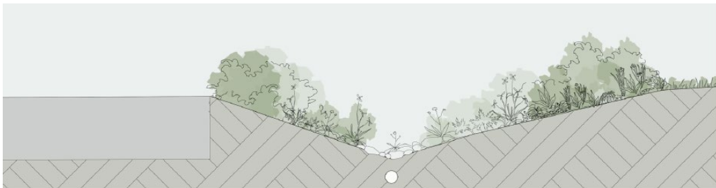
Figur 17. Sektion som visar hur relationen mellan Flyingevägen, infart till planområdet, diket till dagvattendammen och den befintliga trädallén kan komma att se ut.
