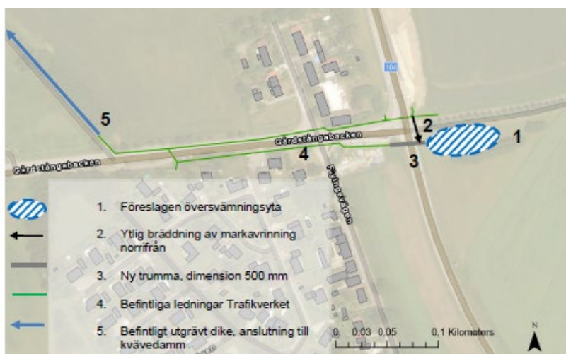
Figur 15. Illustration som visar principlösningen för att skyfallsvattnet som rinner från angränsande jordbruksfastigheter.
