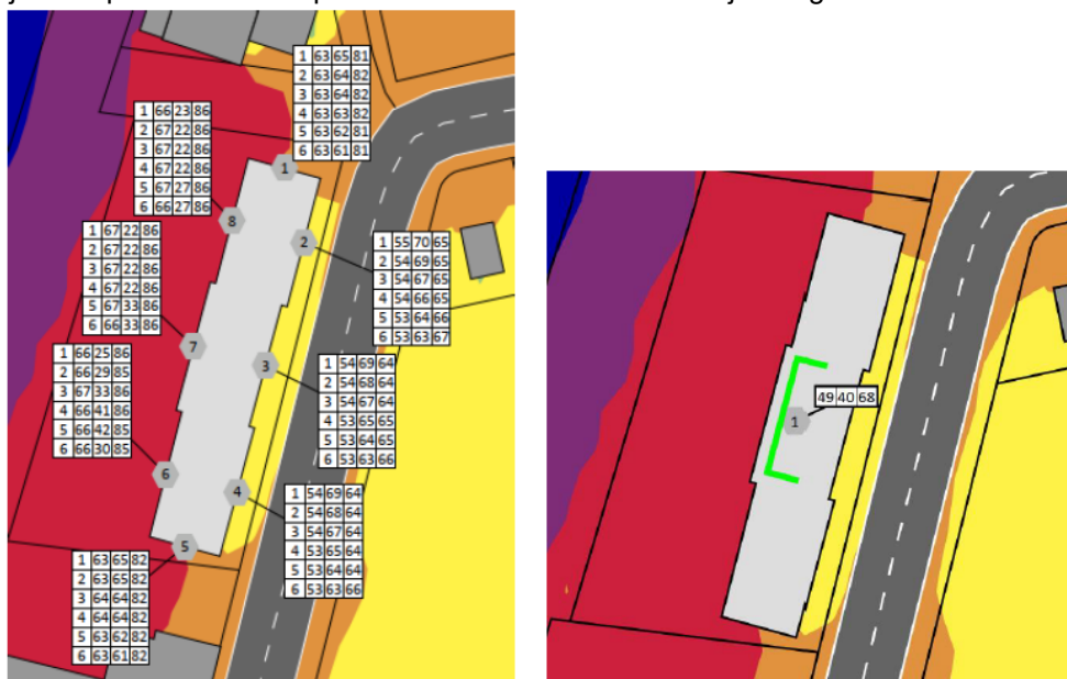
Urklipp från bullerutredning bilaga AK01 och AK05. Beräknade trafikbullernivåer. Tabellerade värden är frifältsvärden och avläses "Våning / L_{eq} / L_{max} väg / L_{max} järnväg". Till höger: bullerskyddad gemensam uteplats på byggnadens tak med 2 meter hög skärm (grön).
