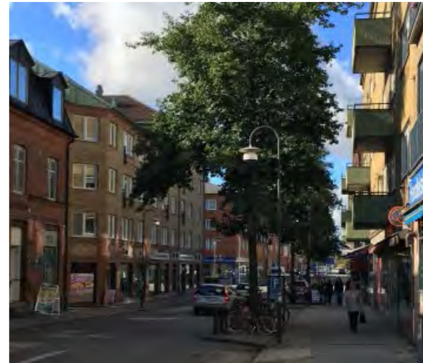
Befintlig belysning på Västergatan. Armaturen Viktoria från Thorn på metkroksarm. Dessa belysningsanläggningar byts successivt ut.
