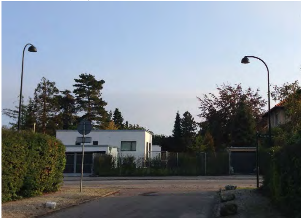
Armaturen Köpenhamn från Philips monterad på en lång böjd arm. Här i två olika höjder för att differentiera en huvudgata från en lokalgata. Foto: ÅF Lighting
