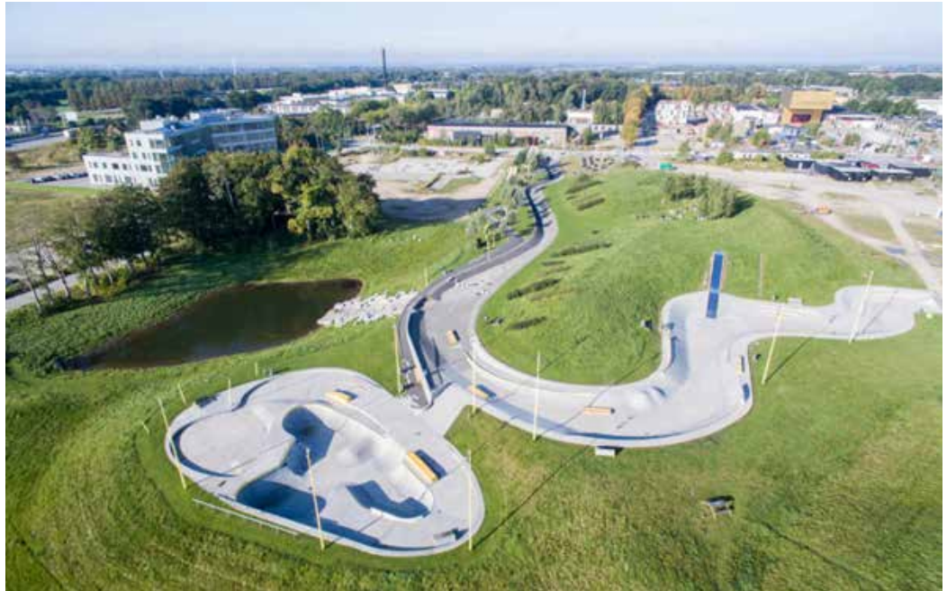
Rabalderparken i Roskilde, en del av stadsdelen Musicon där en skejtpark används för dagvattenhantering (GHB Landskabsarkitekter / Jacob Borg Damkjær, 2017)
