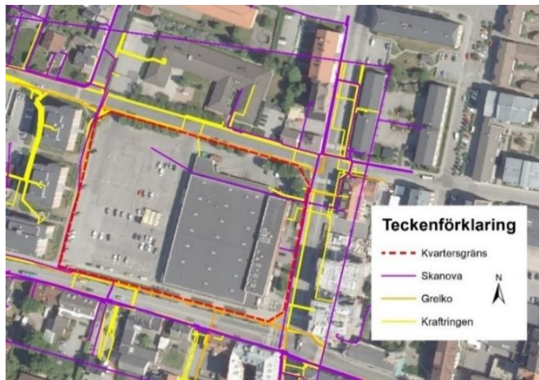
Figur 4-4. Övriga ledningar som kan komma att behöva tas hänsyn till vid exploatering av planområde.
