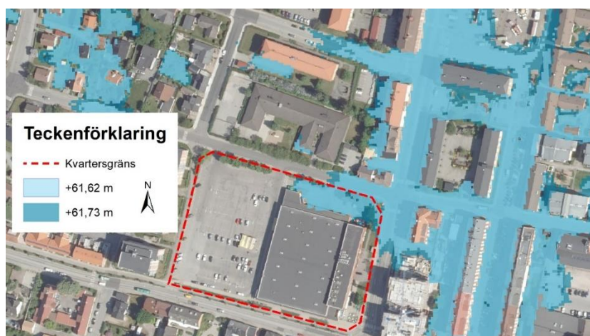
Figur 8-1. Översvämningskartering för olika tillåtna utflöden från planområde.
