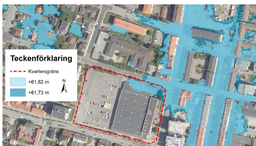
Figur 8-1. Översvämningskartering för olika tillåtna utflöden från planområde.
