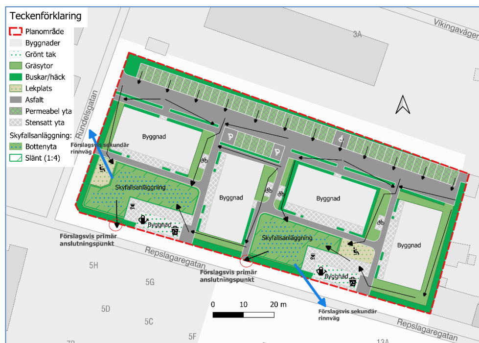
Figur 7-1. Principiellt åtgärdsförslag, svarta pilar motsvarar principiell flödesavrinning mot anläggning och blå pilar motsvarar föreslagna sekundära rinnvägar.
