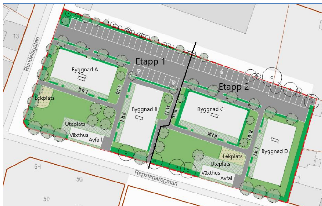
Figur 3-3. Markanvändning och övergripande indelning av fastigheterna (A, B, C och D) i planområdet samt de två etapperna i vilka ombyggnad ska utföras enligt framtagna situationsplan av Tengbom AB (2025).
