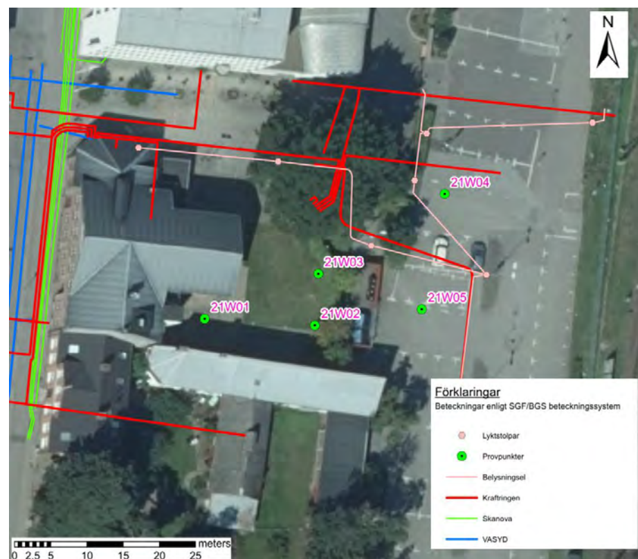
Figur 3.6. Ledningskart, urklipp från uppritad borrplan. Interna ledningar är inte redovisade.
