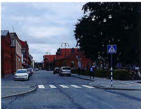
Övergångsställe intill tågstationen med ledstråk och avfasning, Storgatan
