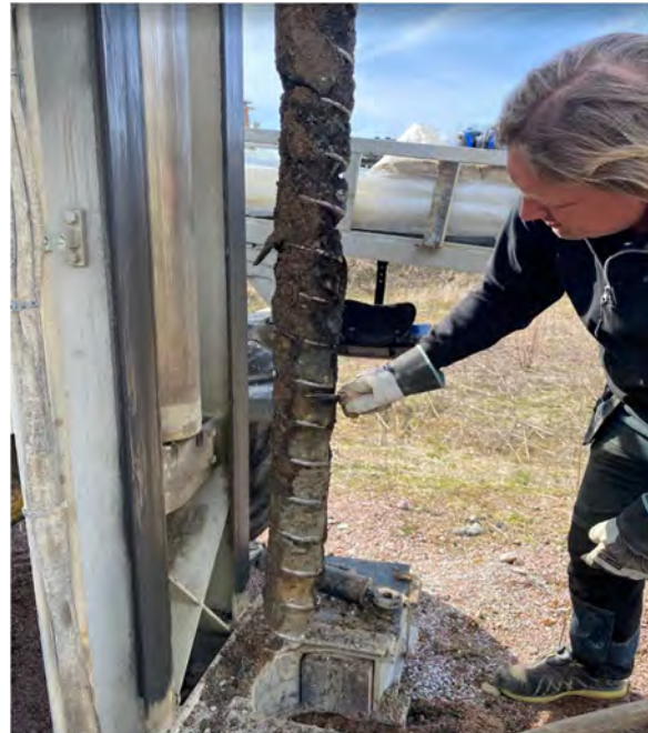
Bild 2. Kontroll av jordlagerföljd
