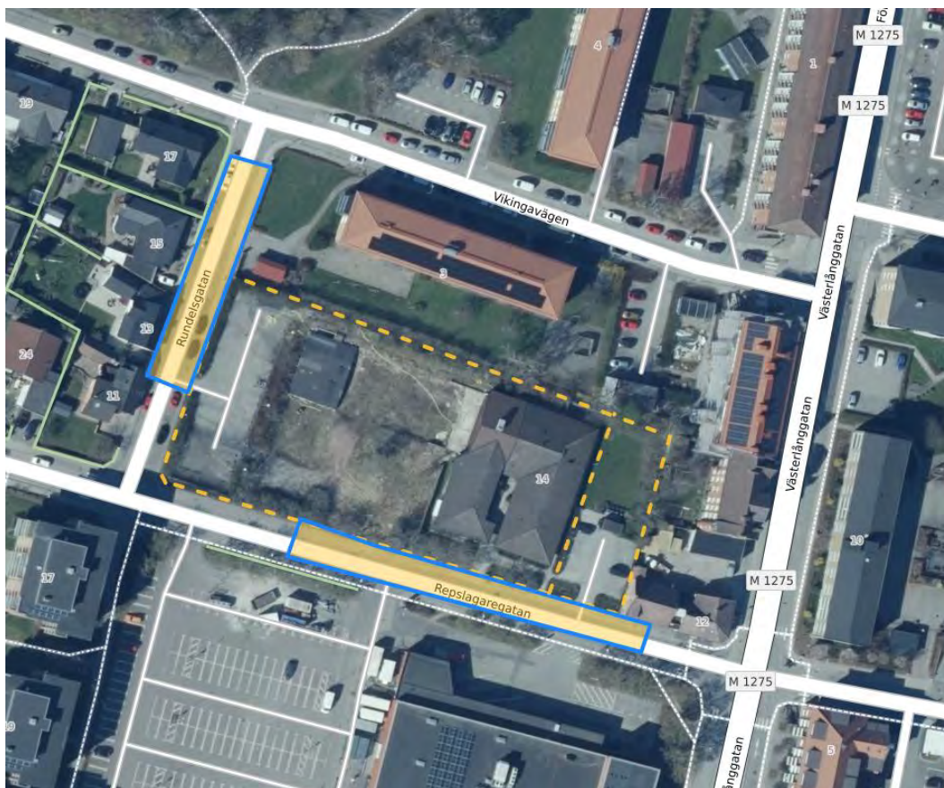
Figur 7.1.2. Ungefärlig placering för rörmagasin i gatorna.
