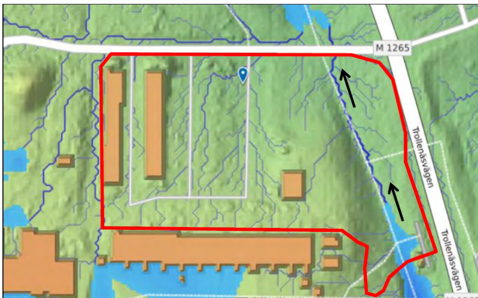
Figur 78 Ansamling av vatten vid ett 100-årsregn med 10 minuters varaktighet i dagsläget. I sydöstra hörnet ansamlas dagvatten, som sedan rinner norrut ut ur området (Scalco Live, 2021).
