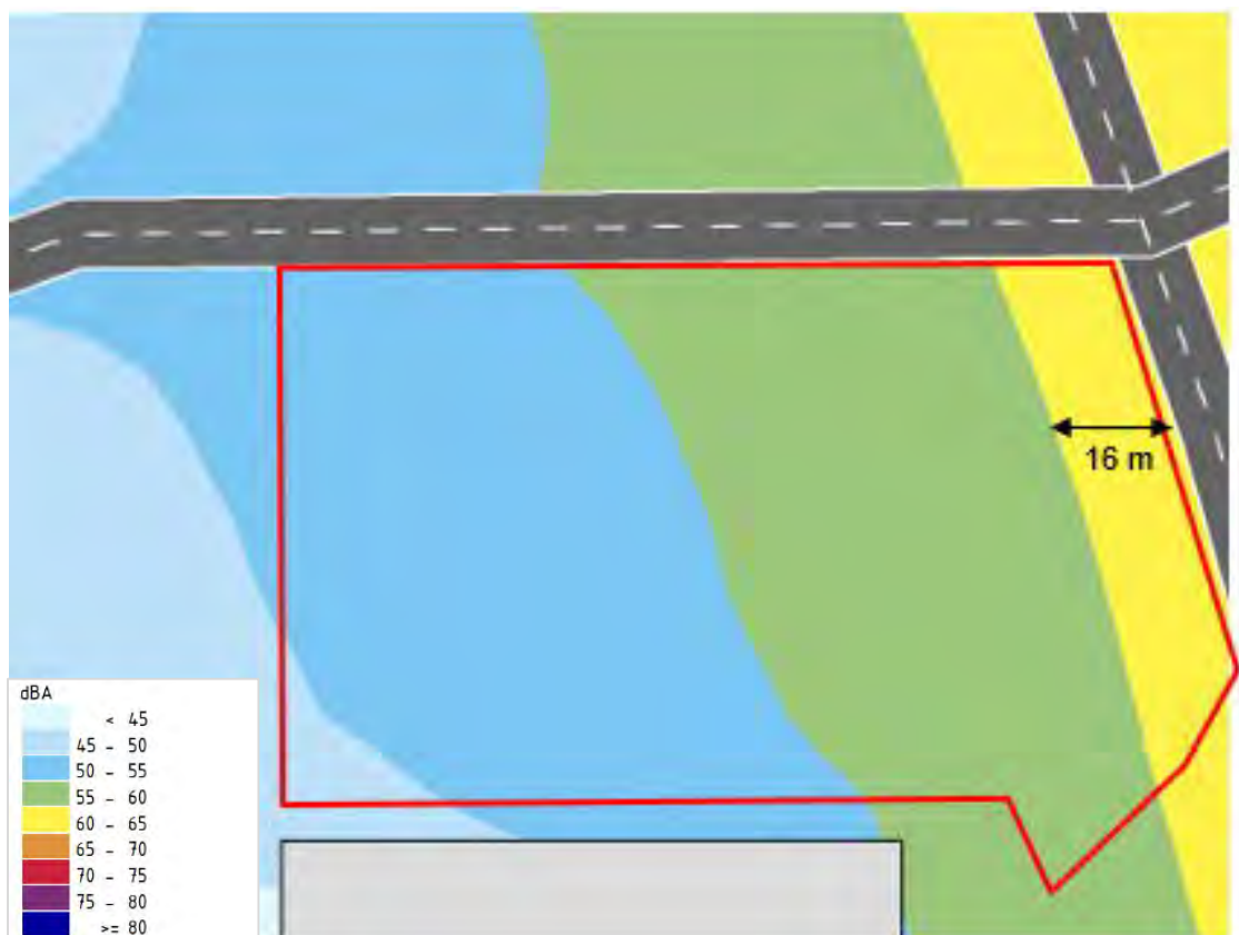
Figur. Färgzonskarta som illustrerar ljudnivån, 8 möm, för prognosår 2040. Röd linje markerar ungefärlig planområdesgräns. Ljudnivån i planområdet är som högst på denna höjdnivå.
