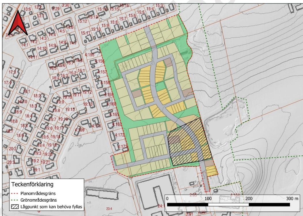
Figur 11. Svacka och lågpunkt som behöver fyllas.
