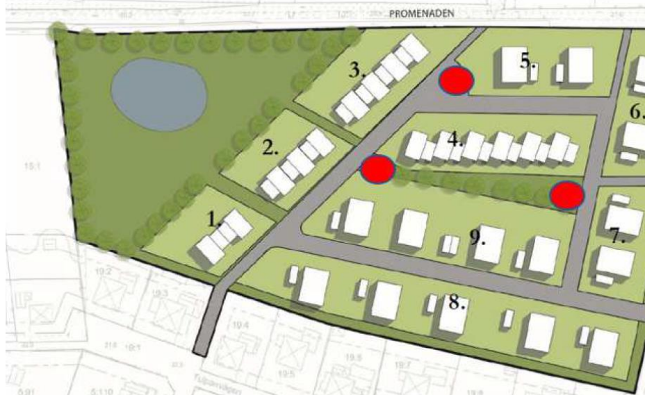
Förslag på alternativa placeringar av nätstation, bild från Skånska Energi.
