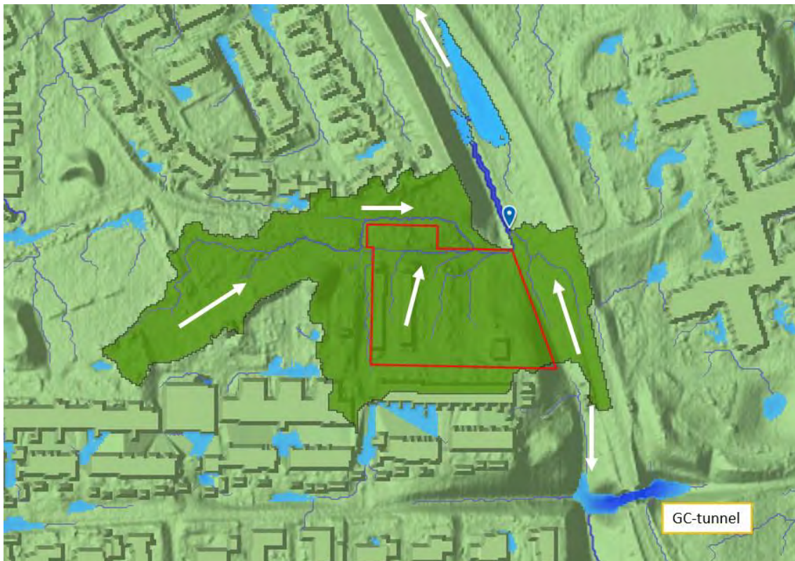
Figur 13. Ansamlingar av vatten vid ett 100-årsregn med 10 minuters varaktighet i dagsläget. Grönt område visar lokalt avrinningsområde till markering (Scalگو Live, 2024).
