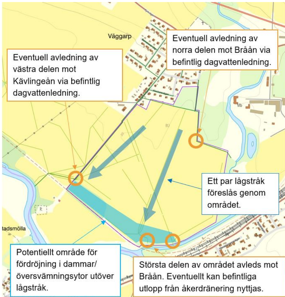
Figur 14. Föreslagen övergripande principutformning för dagvatten- och skyfallshantering. Ledningar som syns i figuren är dagvattenledningar och åkerdräneringens stammar (se även Figur 10, som visar befintliga ledningar).
