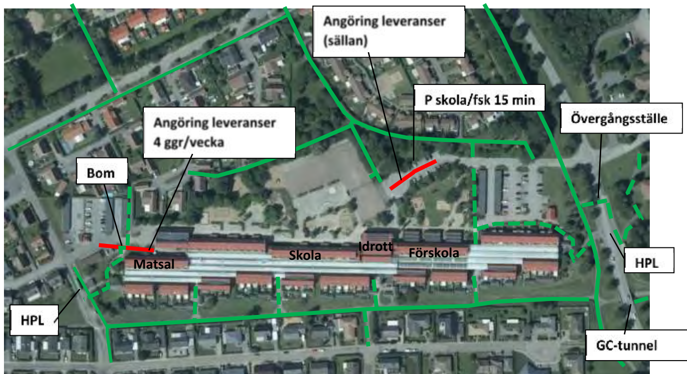
Figur 5. Befintliga gång- och cykelstråk in till skolan markerat med grönt och angöring för leveranser markerat med rött.
