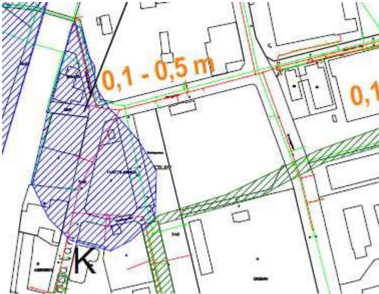
Figur ovan: Utdrag ur Swecos utredning efter skyfallet i Eslöv 2006. Regnet som orsakade översvämning motsvarade, enligt beräkningarna, ett 40-årsregn. Blåmarkerat område är baserat på privatpersoners och tjänstemäns bilder och berättelser och försäkrings/skyfallsutredningen som Sweco gjorde efter händelsen. Abborren 9 ligger inom det blåmarkerade området.
