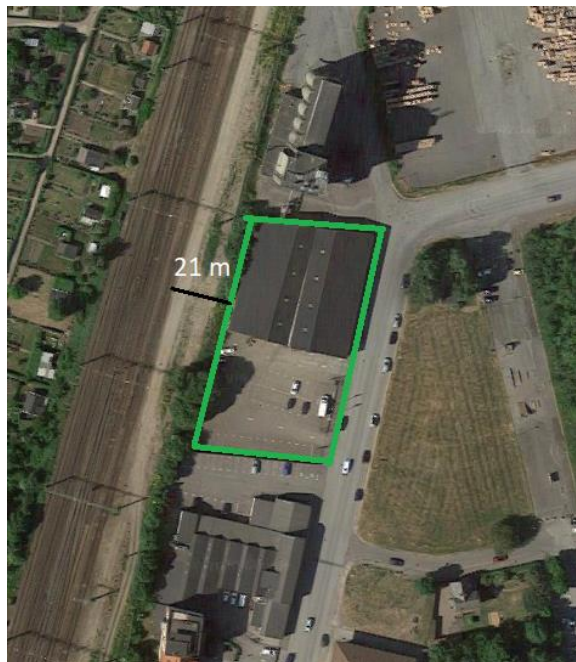
Figur 2: Avstånd mellan fastighetsgräns och spår 6, Södra stambanan.
