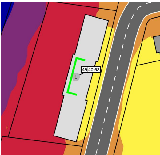
Figur 3. Urklipp från bilaga AK05. Beräknade trafikbullernivåer vid bullerskyddad uteplats på byggnadens tak. Grön markering är skärm. Tabellerade värden avläses "Leq / Lmax väg / Lmax järnväg". Maxnivåer från järnväg avser godstågspassage (högsta nivå).
