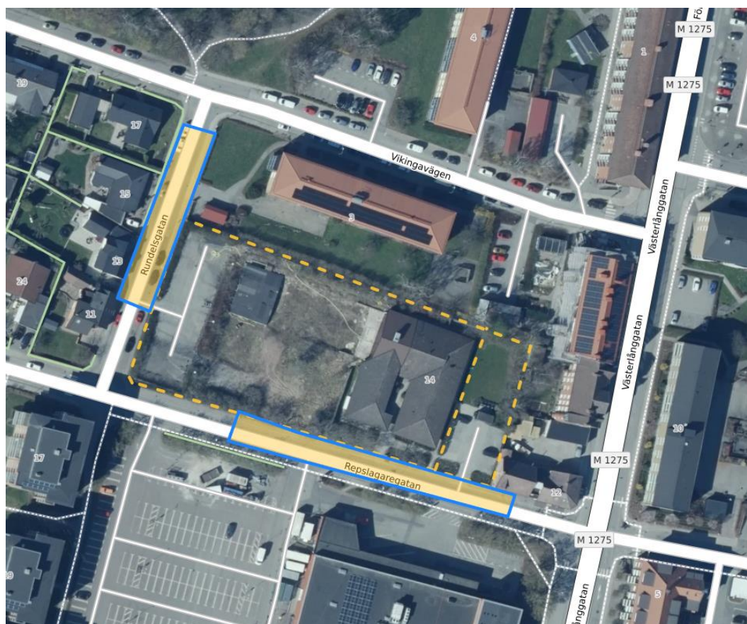
Figur 7.1.2. Ungefärlig placering för rörmagasin i gatorna.
