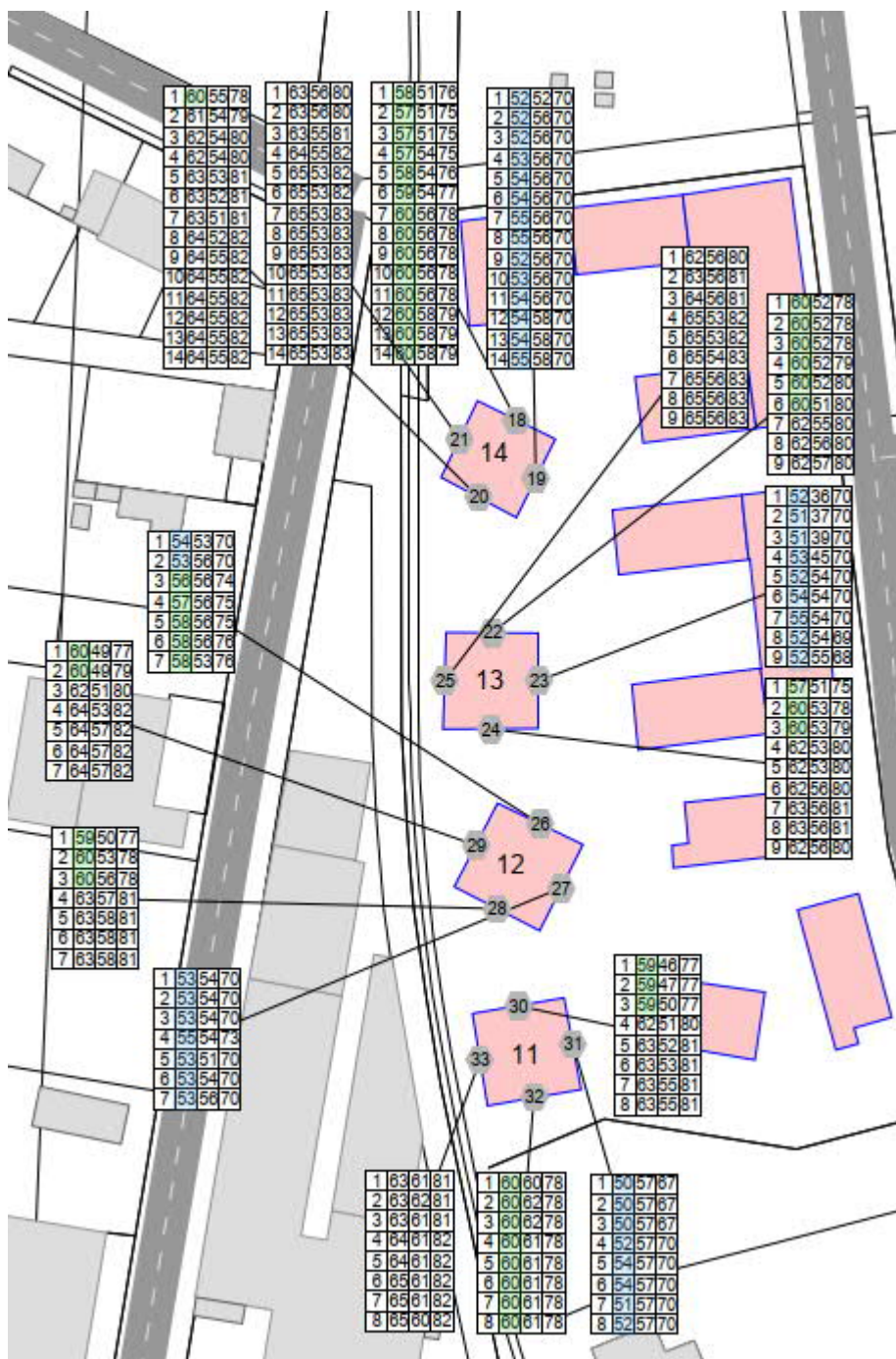
Figur 4. Utklipp från AK01B som illustrerar fasadnivåer som frifältsvärden på del av fastigheten Örn 4 för prognosår 2040. I kolumnerna för fasadnivåer anges hur Leq (dBA) (2: a kolumnen) och Lmax järnväg (3:e kolumnen) och Lmax väg (4:e kolumnen) fördelas per fasad och våningsplan (1: a kolumnen). Tabellerna är markerade med två olika färger. Grön färg anger att grundriktsvärdet Leq 60 dBA uppfylls, medan blå anger att även "ljuddämpad sids" uppfylls. Järnvägen löper väster om planområdet.
