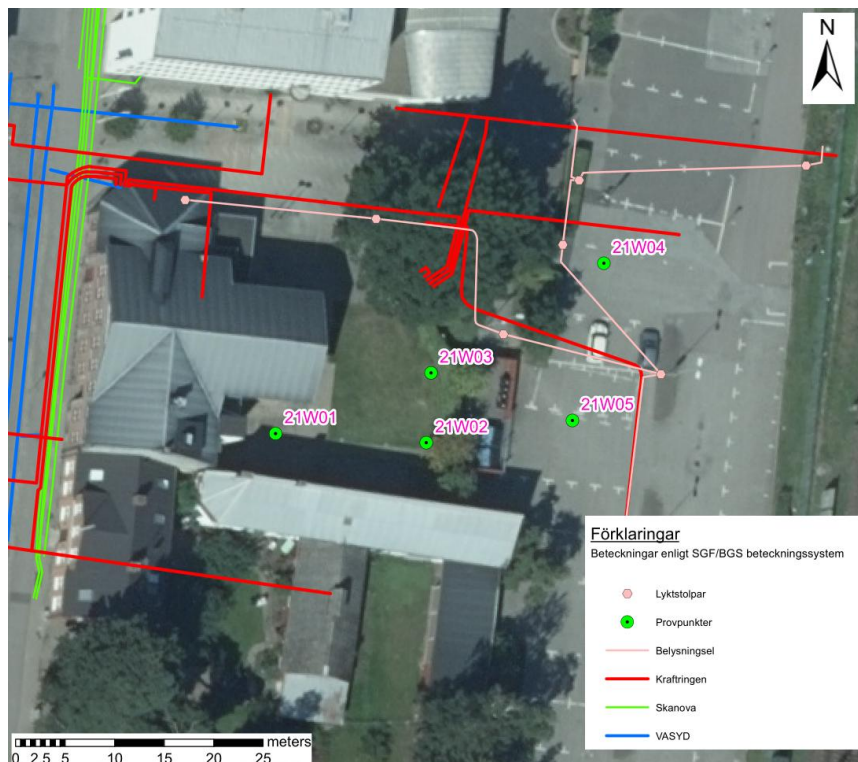
Figur 3: Ledningskarta. Urklipp från uppritad borrplan, interna ledningar ej visas här.
