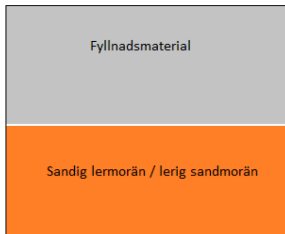
Figur 2: Principiell skiss över dimensionerande jordlagerföljd.
