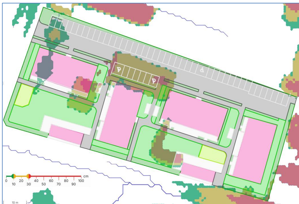
Figur 6-1. Stående vattendjup för planerad detaljplan utan skyddsåtgärd mot skyfall för ett 100-årsregn (77,5 mm) med 74 minuters varaktighet samt utan infiltration (SCALGO Live).
