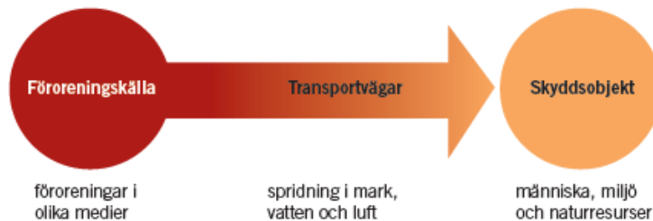
Figur 2. En risk föreligger när förorening från en källa (jord, grundvatten, sediment, byggnader och anläggningar) frigörs och via olika transportvägar sprids och exponerar skyddsobjekt (människa, miljö, naturresurser) så att en negativ effekt riskerar att uppstå. (Naturvårdsverket, 2009b)
