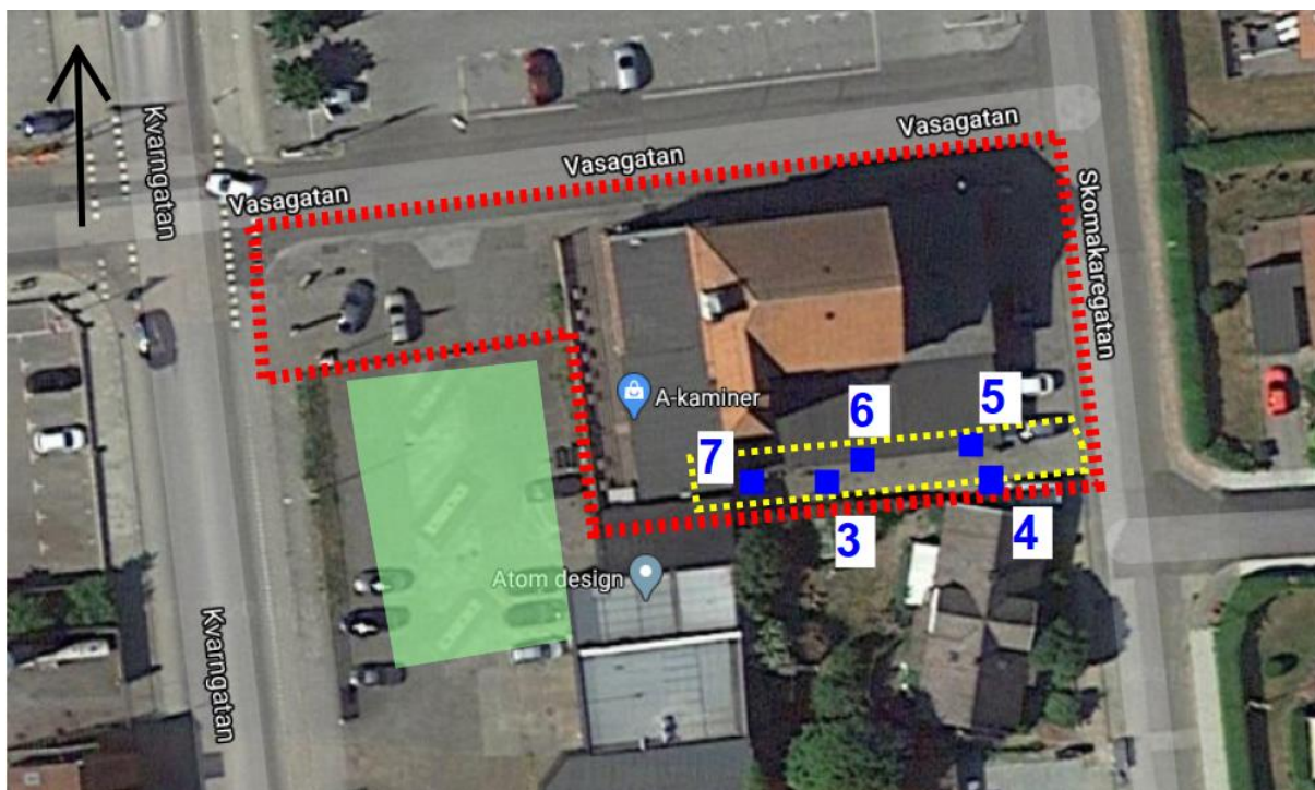
Figur 1. Översiktbild över aktuellt område. Falken 10 markerad i röd figur, tidigare läge för bensinstation inom Falken 6 markerat med grön figur, lägen för provpunkter utförda utomhus markerade med blå fyrkanter, gul figur visar det område som riskbedömningen avser
