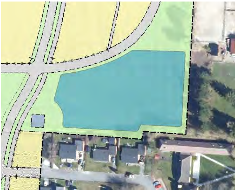
Figur 34. Exempel på en ungefärlig yta, drygt 5200 kvadratmeter stor, som behöver ianspråktagas för fördröjningsdammen om den utformas med ett djup på cirka 0,6 meter och slänter med lutning 1:5.
