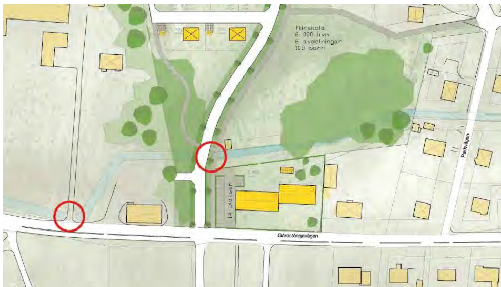
Figur 49. De två befintliga trummorna som behöver förstoras.
