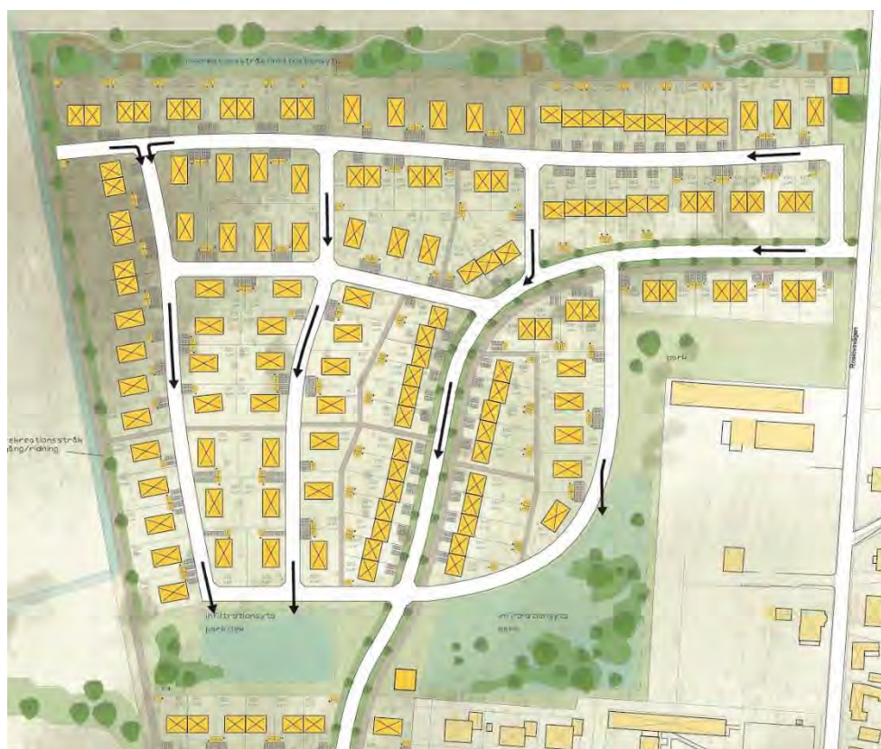
Figur 48. Princip för avrinning längs gator i den norra delen av planområdet.
