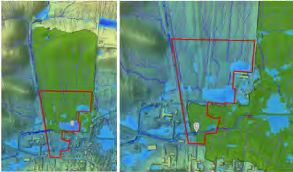
Figur 41 och 42. De två avrinningsområdena, gröna ytor, som planområdet ingår i. Till vänster visas avrinningsområdet som den norra delen av planområdet ingår i. Avrinning sker till ett öppet dike och avleds till ett dike väster om planområdet via kulvert. Till höger visas del av det avrinningsområde som den södra delen av planområdet ingår i. Avrinning sker till dike som rinner genom planområdet i söder. (Dagvatten- och skyfallsutredning Östra Gårdstånga, 2022-04-13).
