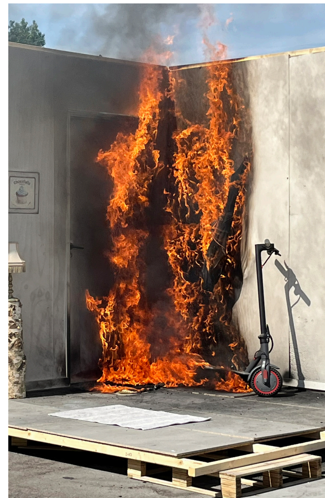
Simulering av batteribrand
