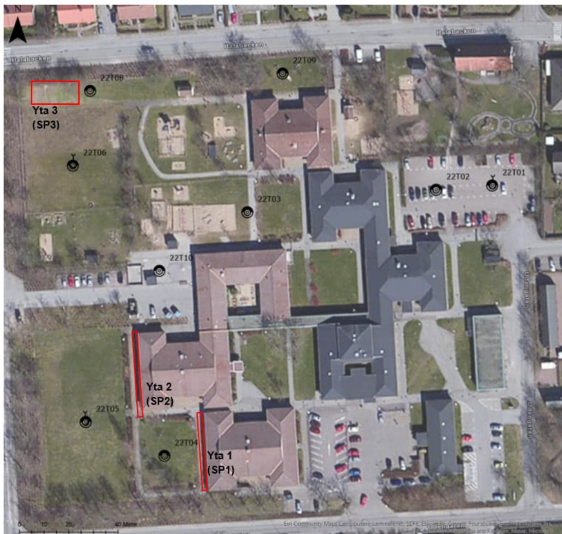
Figur 3. Karta med undersökningspunkter som genomfördes under 2022-2023. Punkter utförda genom skruvprovtagning markerade med rund figur och med grundvattenrör i 22T01, 22T05 och 22T06 samt ytor för ytlig provtagning med röda figurer för respektive yta. © ESRI Community Map
