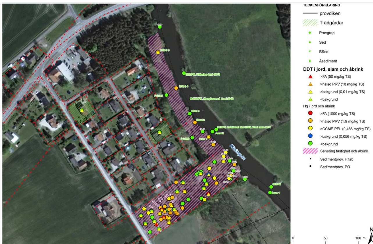
Figur 26: Massor aktuella för bortschaktning enligt åtgärdsalternativ 4. Figuren visar även kvicksilver och DDT-halter i förhållande till platsspecifika riktvärden.
