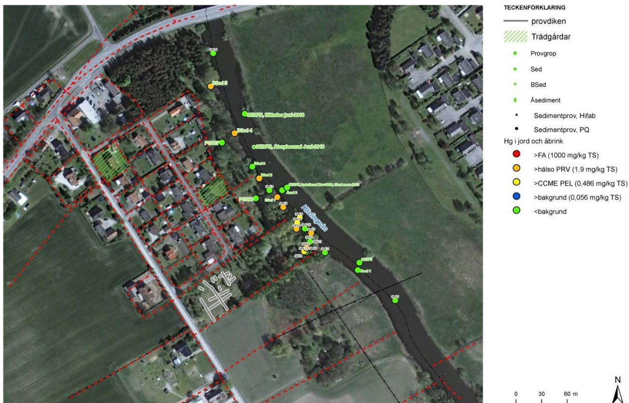
Figur 14: Provpunkter längs med åbrinken där halten kvicksilver i jord och sediment i åbrinken överstiger det beräknade platsspecifika hälsoriskbaserade riktvärdet för mark, det kanadensiska lågriskvärdet (CCME PEL) samt det föreslagna gränsvärdet för farligt avfall (FA).
