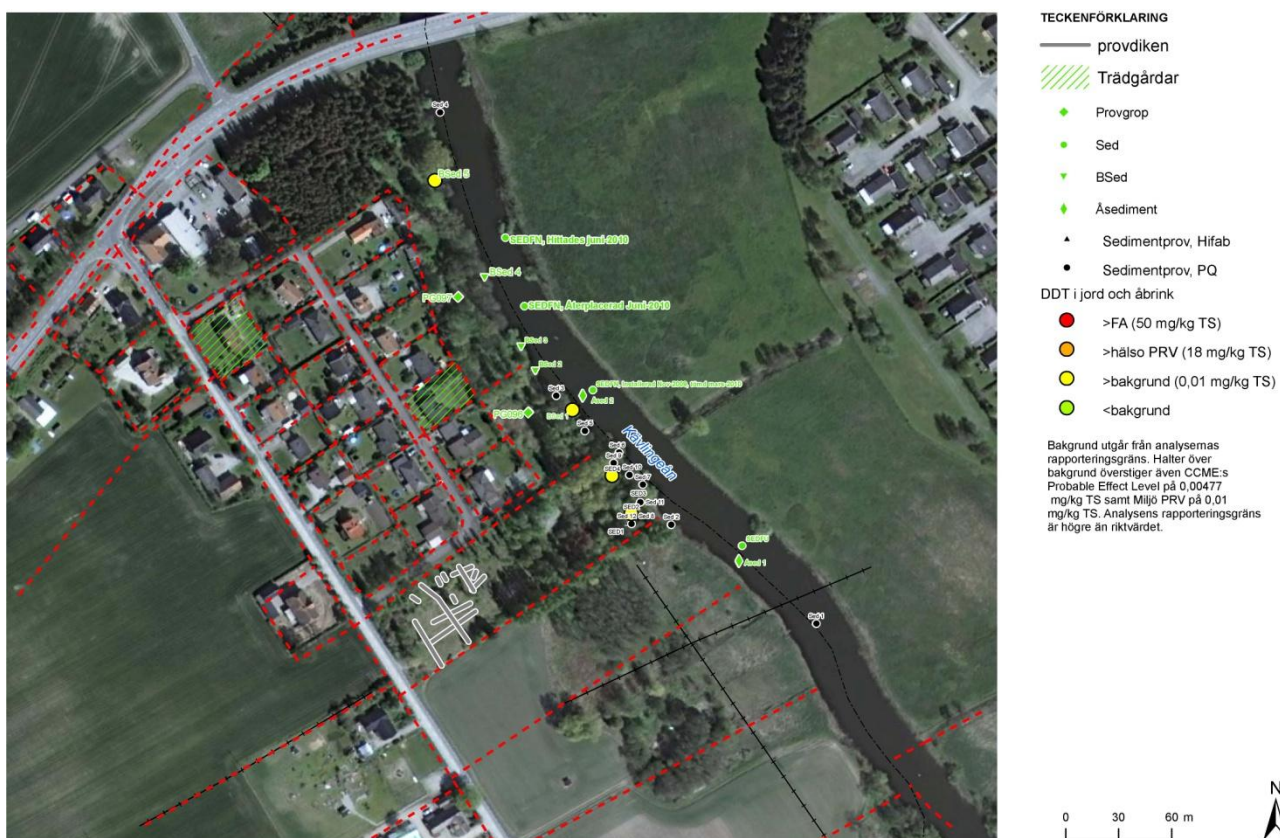
Figur 15: Provpunkter längs med åbrinken där halten DDT i jord och sediment i åbrinken överstiger det beräknade platsspecifika hälsoriskbaserade riktvärdet för mark, det kanadensiska lågriskvärdet (CCME PEL) samt det föreslagna gränsvärdet för farligt avfall (FA).
