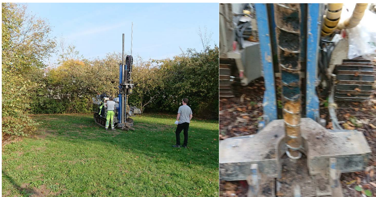
Figur 18: Provtagning i GA20 2018-10-17 och blått material på skruven (bilden av skruven är dessvärre oskarp).
