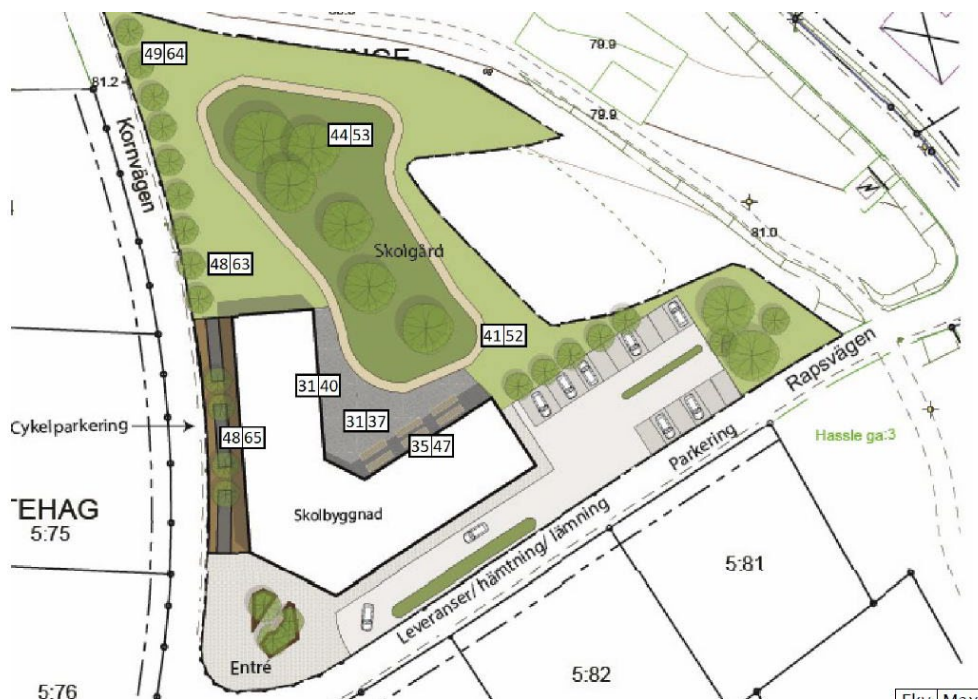
Figur 5. Beräknade trafikbullernivåer 1,5 meter ovan mark. Ekvivalent och maximal ljudnivå vid prognosåret 2040.
