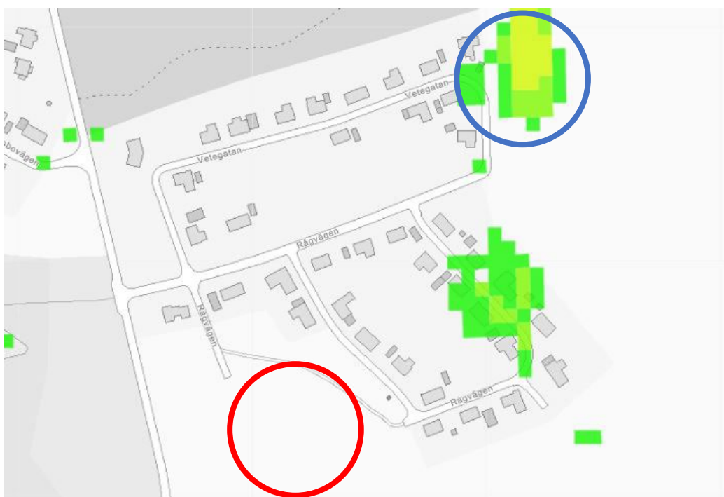
Figur 4: Illustration över lågpunkter i planområdets närhet. Gröna punkter illustrerar lågpunkter på 0.1–0.5 m. Gul-gröna punkter illustrerar lågpunkter på 0.5-1.0 meter. Gula punkter illustrerar lågpunkter på 1.0–1.5. Planområdet är inom röd heldragen cirkel. En dagvattendamm är inplanerad vid den nordöstra lågpunkten markerad med blå cirkel. Dagvattendammen regleras i gällande detaljplan S 15.
