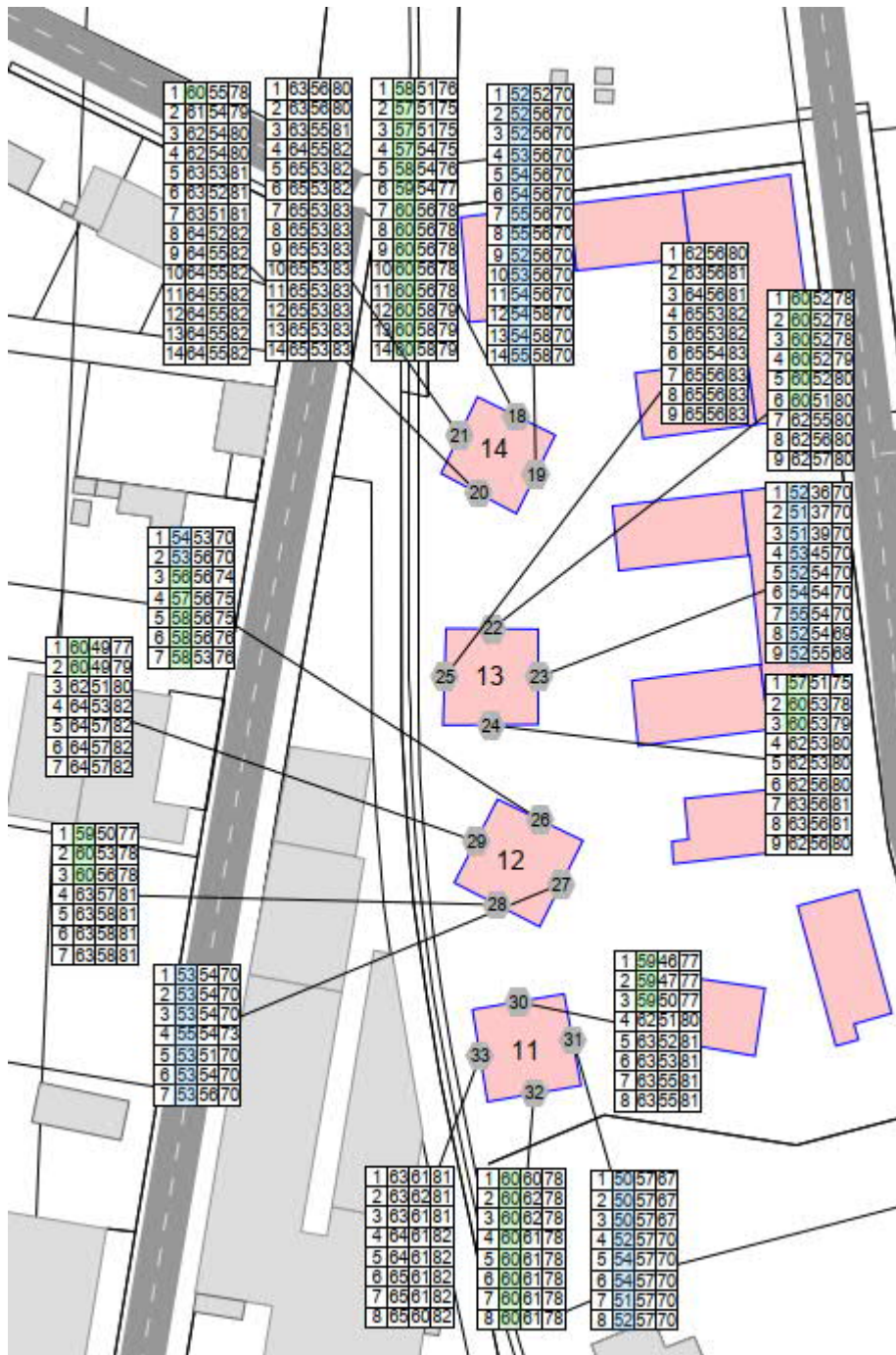
Figur 4. Utklipp från AK01B som illustrerar fasadnivåer som frifältsvärden på del av fastigheten Örnén 4 för prognosår 2040. I kolumnerna för fasadnivåer anges hur Leq (dBA) (2: a kolumnen) och Lmax järnväg (3:e kolumnen) och Lmax väg (4:e kolumnen) fördelas per fasad och våningsplan (1: a kolumnen). Tabellerna är markerade med två olika färger. Grön färg anger att grundriktsvärdet Leq 60 dBA uppfylls, medan blå anger att även "ljuddämpad sids" uppfylls. Järnvägen löper väster om planområdet.
