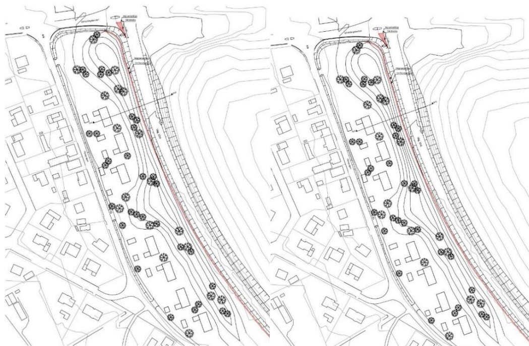
Figur 2. Utbyggnadsförslag med hög bullervall mot väg 104. Till vänster: 2-3 m hög vall. Till höger: 3 m hög vall. Källa bild: Danielsen Urban Landscape
