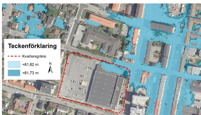
Figur 8-1. Översvämningskartering för olika tillåtna utflöden från planområde.
