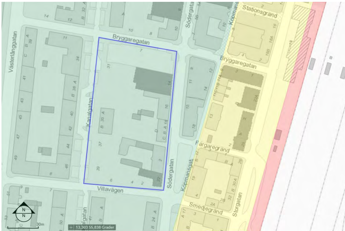
Figur 7 - Individsk utifrån närmsta räl. Blå rektangel markerar kv. Färgaren. Rött område - hög risk, individsrisken > 10^{-5} . Gult område - ALARP-området, 10^{-7} < \text{individsrisk} < 10^{-5} , där risken anses tolerabel förutsatt att alla rimliga åtgärder vidtagits. Grönt område - tolerabel risk, individsrisk < 10^{-7} . Riskzonerna gäller endast utifrån aktuella förhållande och för avsedd bebyggelse på kv. Färgaren. (Bakgrundskarta är hämtad från Eslöv kommuns kartportal)
