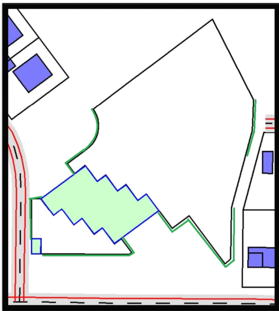
Figur 6. Överblick av objektet och en grov estimering av var bullerplank anses nödvändiga. Detta är markerat i grönt.
