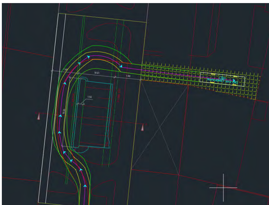
Figur 10 Analys av körspår på Kanalgatan motsvarande en 12 m lastbil.
