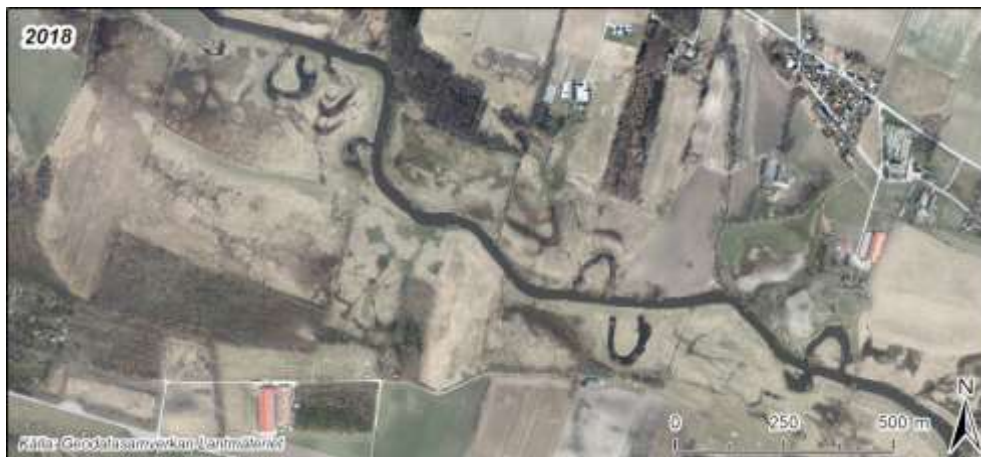
Figur 3.6: Flygbild över ett utsnitt av en uträtad del av Kävlingeåns huvudfåra. Gamla meanderbågar syns fortfarande tydligt vid sidan av det uträtade vattendraget
