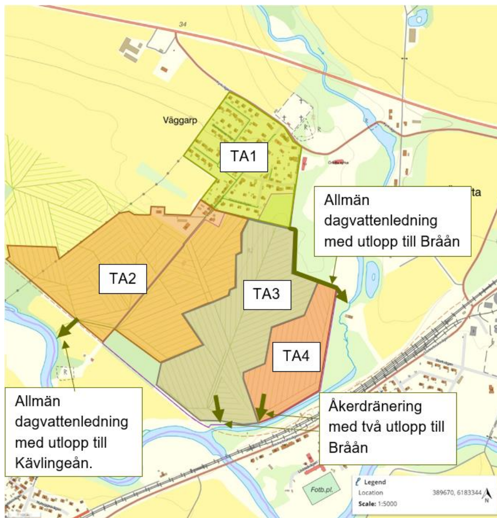
Figur 6. Tekniska avrinningsområden (Scalco ApS, 2022). Kartan har kompletterats med underlag avseende befintligt ledningsnät från VA SYD och markägare. Gröna pilar visar ungefärliga lägen för utlopp till recipienter. Utredningsområdet visas med lila linje.
