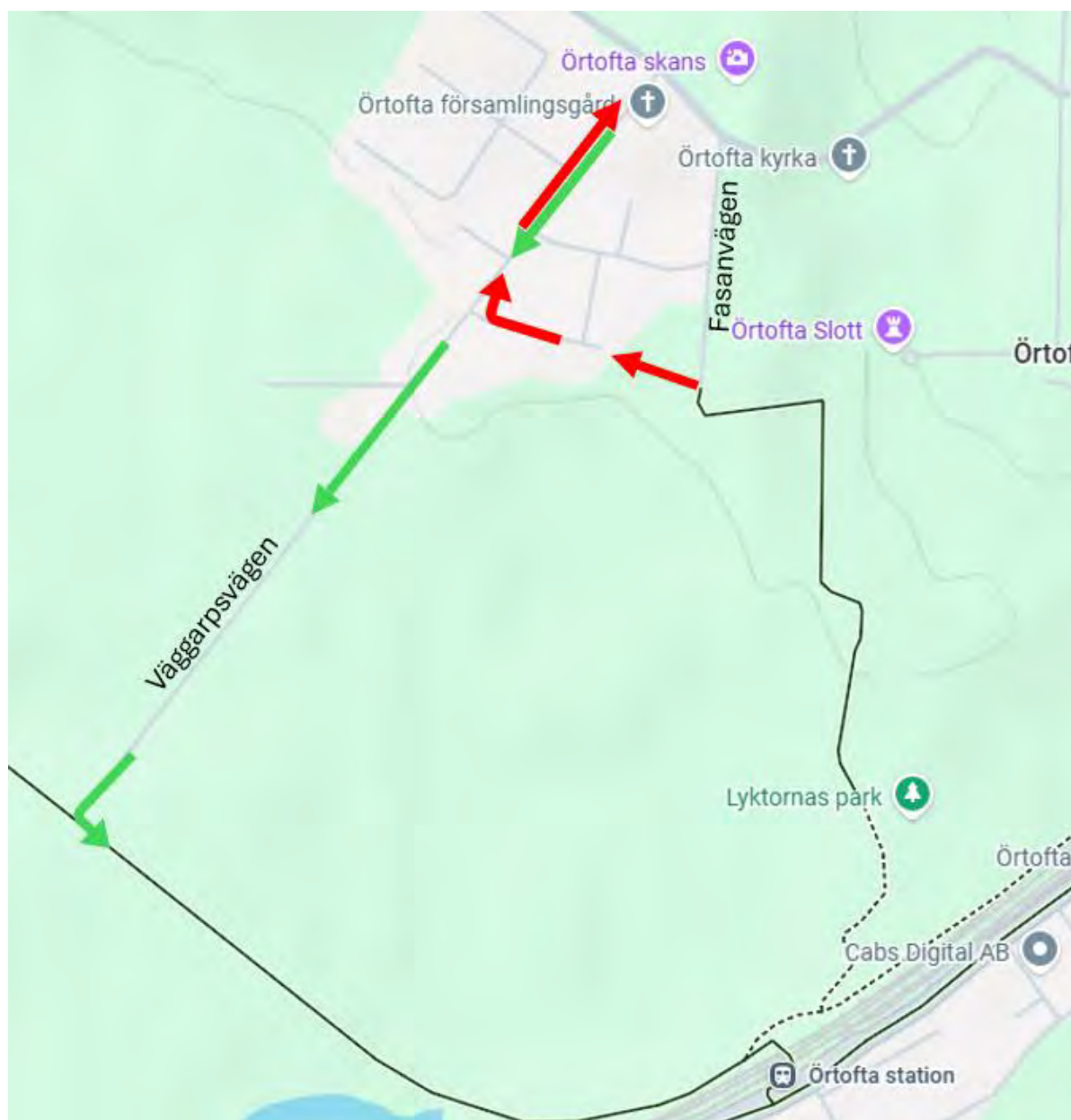
Figur 24. Förslag på hänvisning och omdirigering av cyklister och fotgängare. Cykelstigar är markerade i svart. Gröna pilar visar hänvisning för trafikanter som kommer norrifrån. Röda pilar visar omdirigering av trafikanter som kommer på cykelstigen söderifrån. Karta: Google maps.
