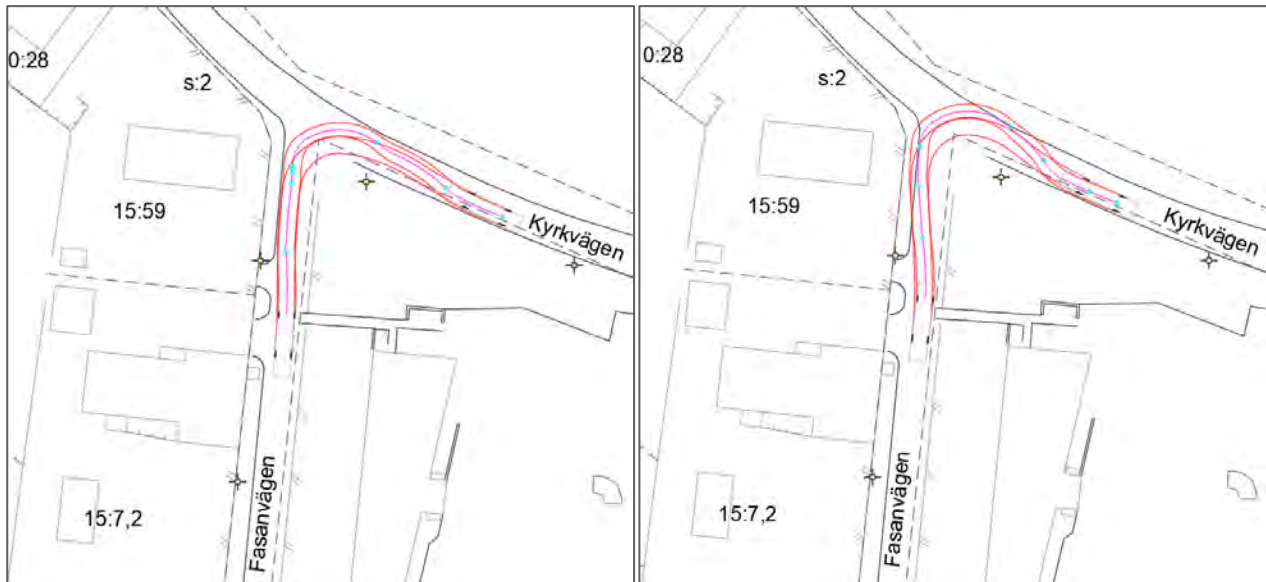
Figur 11. Högersväng från Fasanvägen till Kyrkvägen, där fordon sneddar över fastighetsgränsen i östra hörnet alternativt kör utanför vägbanan på både Fasanvägen och Kyrkvägen.
