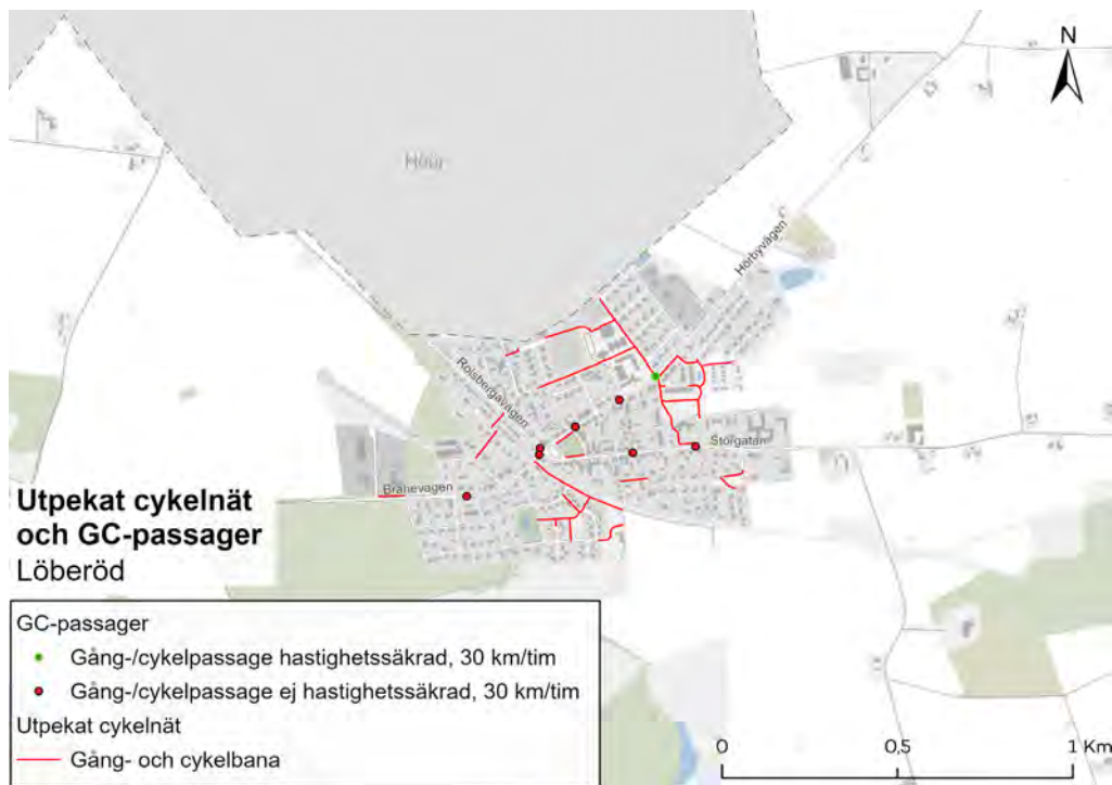
Figur 58. Det av Eslövs kommun utpekade huvudcykelnätet i Löberöd där trafiksäkra passager synliggjorts (hastighetssäkrade/planskilda passager). Inventeringen är översiktlig och kan behöva kompletteras.
