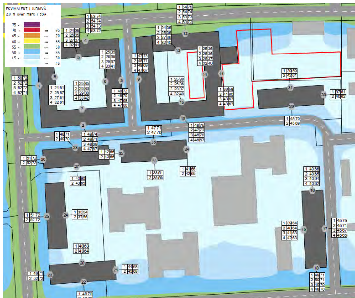
Urklipp ur bilaga AK01. Beräknade ljudnivåer från vägtrafik, prognosår 2040. Tabellerade värden avser frifältsvärden och avläses "Våning / Leq / L_{max} ". Planerad förskolegård är markerad med rött.
